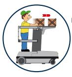
Le support de chargement à hauteur maximum coïncide avec l'hauteur de la colonne. C'est très pratique même pour les paquets les plus lourds, en utilisant la colonne comme base pour appuyer et faire glisser les paquets.
